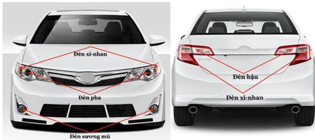
Hình 1.3. Hệ thống chiếu sáng, tín hiệu trên xe ô tô
